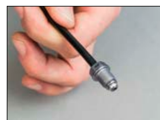
Proceso de rebordeado DIN
