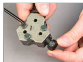
Proceso de rebordeado DIN
