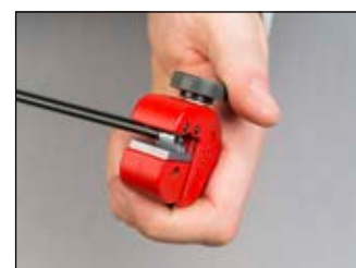
Posicionamiento del conducto para raspar el revestimiento
