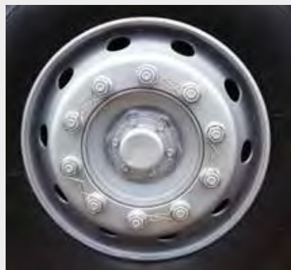
How to measure the pitch circle diameter (PCD) Come misurare l'interasse delle colonnine
